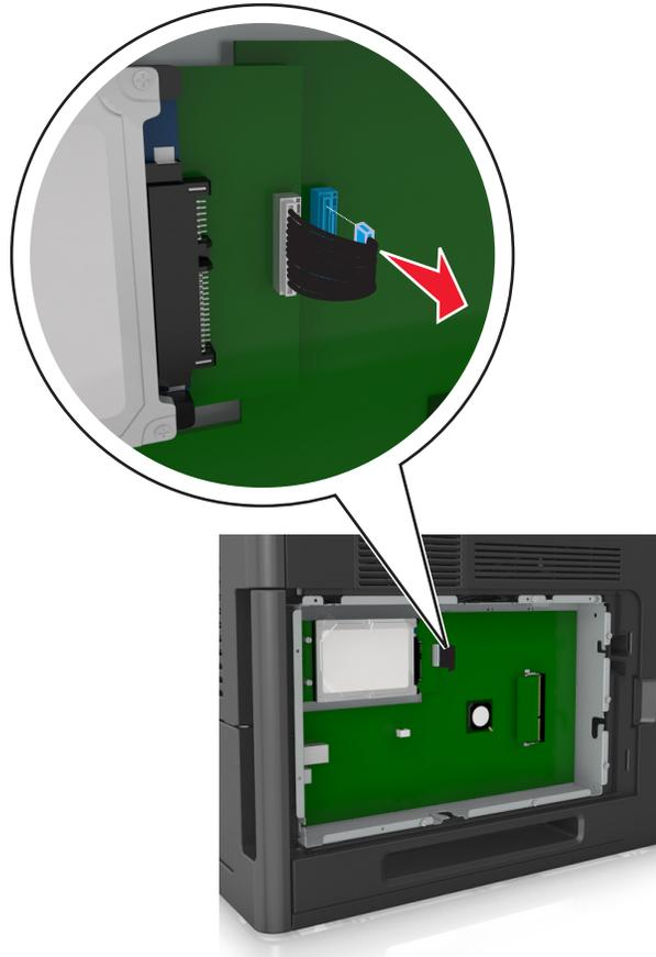
3 取出用於固定印表機硬碟的螺絲。
