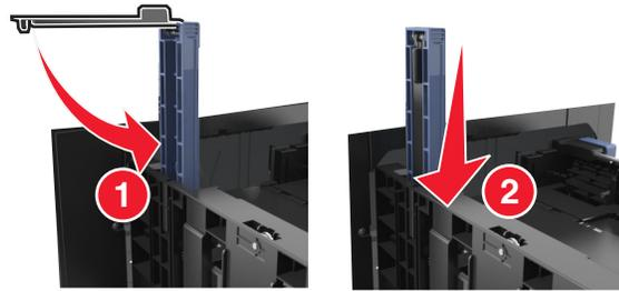
d 捏住長度導引夾，將它滑到所載入紙張尺寸適用的正確位置，直到它發出喀嚓一聲，卡入定位。
