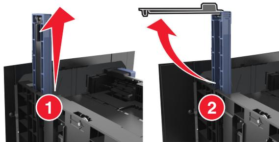
**d** 將 A5 長度導引夾插入它的指定插槽。
