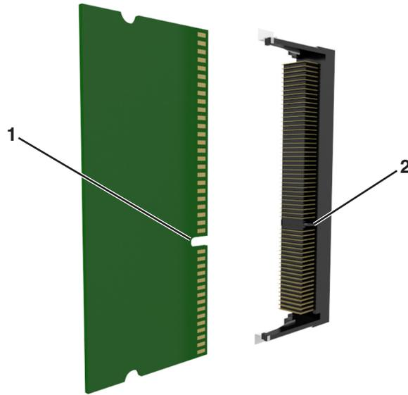
**4** 將記憶卡垂直推入連接器中，然後將插卡推向控制板內壁，直到它發出喀嚓一聲，卡入定位。
