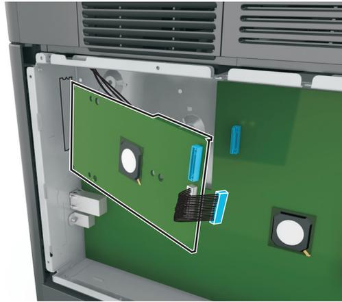
**請注意：**以某個角度將 ISP 擺放至塑膠支架上方，使懸空的所有連結器，都能穿過控制板箱匣中的 ISP 開口處。
