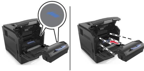
**警告—潛在損害：**更換碳粉匣時，請不要讓成像組件曝露於直接照射的光線過久的時間。曝露在光線下太久，會導致列印品質發生問題。
