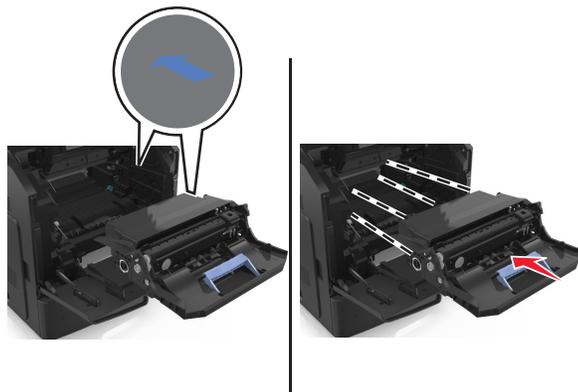
7 將碳粉匣插入印表機，插入時，請將碳粉匣邊欄上的箭頭對準印表機內側邊欄上的箭頭。
